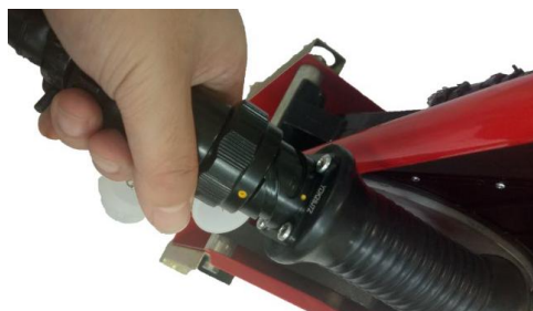
电热板连线与电热板的连接
