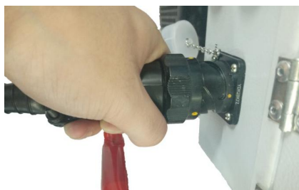
电热板连线与液压站的连接
